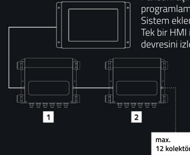
Huracan sisteminin sunduğu kolay bağlantı özelliğinden ilham alın. Paketini açın, takın, kullanıma hazır! Huracan sistemi sizi zaman alıcı programlama ve kablolalama ile uğraşmak zorunda bırakmaz. Sistem eklenen her HRC kolektörünü anında algılar. Tek bir HMI ile 12 HRC Pro'ya kadar çoğaltılabılır ve 72 soğutma devresini izlemenize olanak sağlar.
